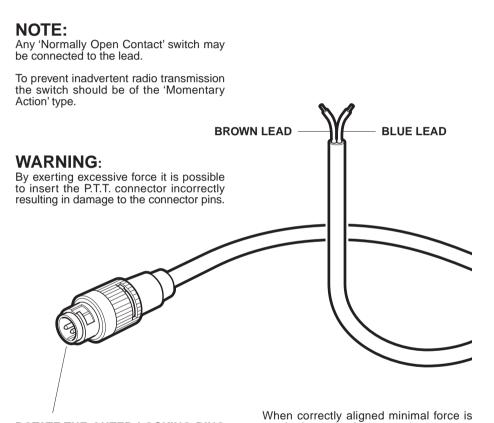
ROTATE THE OUTER LOCKING RING TO ALIGN THE KEY WAYS BEFORE **INSERTING THE PLUG.**
